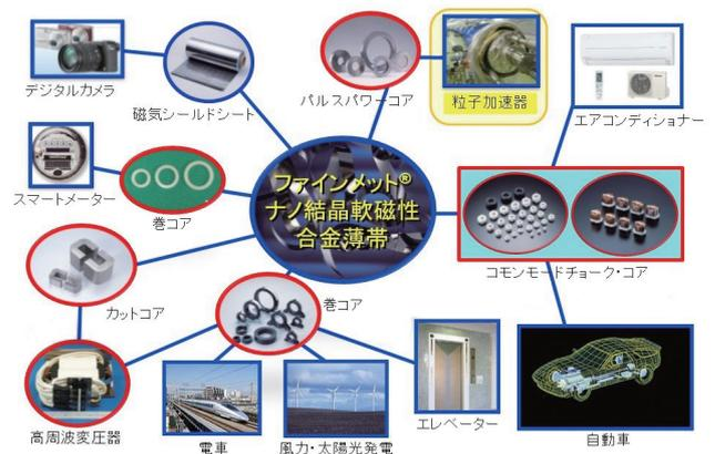
Fig. 7 ナノ結晶軟磁性材料ファインメットの応用例
